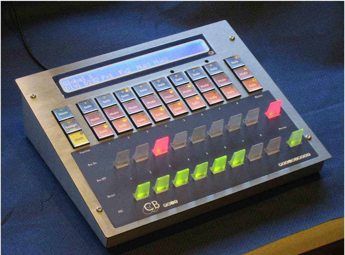
Le PD-1 offre une nouvelle approche pour l'implémentation du concept du panneau de Pec/Direct. Les commutations de Solo, Mute et Source/Lecture sont implémentées dans la Station Audio Numérique pour générer les différentes sources du monitoring (L.C.R.S...) Les commutations réalisées dans la Station Audio Numérique éliminent les interconnexions et le matériel, par exemple un ensemble de commutations pour 48 pistes nécessite normalement 96 entrées audio!
