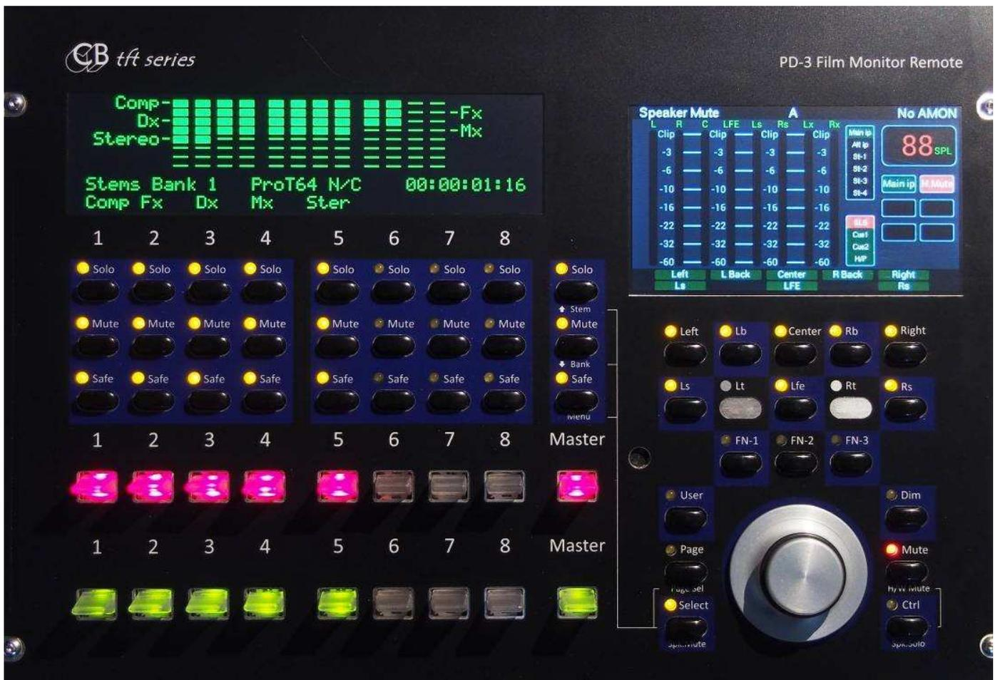
Photo du PD-3 qui comprend un PD-2 et un TMC-1. On peut voir l'affichage O-LED du PD-2, qui inclut l'affichage des pistes armées d'un Stem, configuré sur cette image pour 12 pistes.
