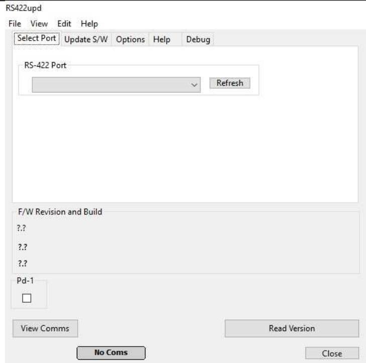
En cochant la case 'PD-1' on active la découverte du bon algorithme de mise à jour. Regarder l'affichage du PD-1 pour savoir si il faut cocher 'PD-1' ou non.
