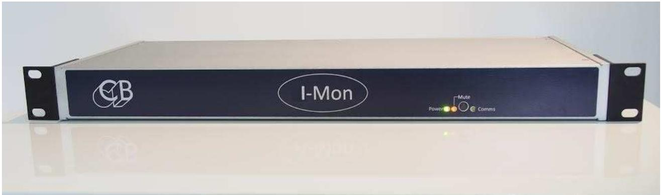
Le contrôleur d'écoute analogique I-Mon est conçu dans un boîtier 1 U que l'on peut mettre en baie 19". Conçu pour la stéréo, le 5.1 le 7.1, le 7.1.4, le 9.1.4 et le 7.1.6 cet appareil polyvalent est conçu pour fournir une solution rentable à l'installation d'un système de contrôle d'écoute dans les petits studios.
